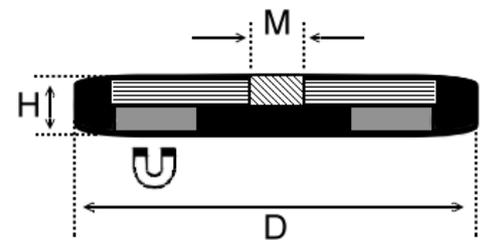
\* Max. Haltekraften werden bei optimalen Bedingungen ermittelt und beziehen sich auf senkrechten Abzug von einer Stahlplatte (Baustahl 10 mm). Bei weniger optimalen Bedingungen (Staub, schlechte Haftgründe usw.) reduziert sich die Haltekraft. Im Alltagsgebrauch von Magneten sind optimale Bedingungen nicht erreichbar. Alle Werte sind ca.-Angaben. 1 kg ≈ 10 Newton.
