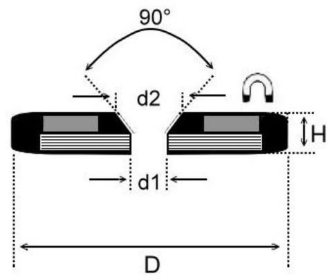
\* Max. Haltekräfte werden bei optimalen Bedingungen ermittelt und beziehen sich auf senkrechten Abzug von einer Stahlplatte (Baustahl 10 mm). Bei weniger optimalen Bedingungen (Staub, schlechte Haftgründe usw.) reduziert sich die Haltekraft. Im Alltagsgebrauch von Magneten sind optimale Bedingungen nicht erreichbar. Alle Werte sind ca.-Angaben. 1 kg ≈ 10 Newton.
